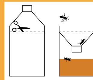
Trampa casera hecha con una botella de plástico a la que se le corta la parte de arriba y se introduce de forma invertida en el orificio hecho. Se perforan ambas partes y se pasa un alambre, el cual se aprovecha para sujetar la tapa de la trampa y colgarla.
